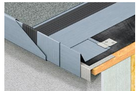
Skizze 38: Dachrand mit dichtender Funktion und Innenentwässerung
