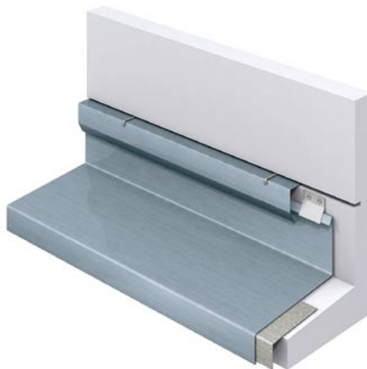
Skizze 25: Kappleiste in Mauerfuge eingelassen
