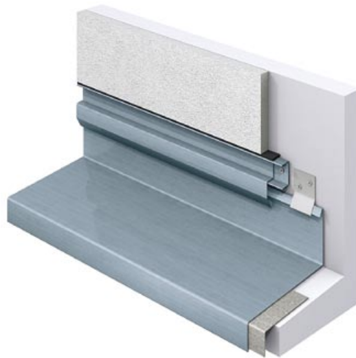
Skizze 24: Putzleiste mit Kappleiste
