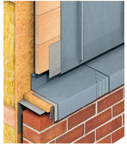
Skizze 18: UDS-Verbinder bei einer Gesimsabdeckung
