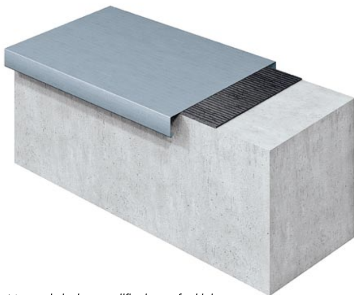
Skizze 5: Mauerabdeckung vollflächig aufgeklebt
